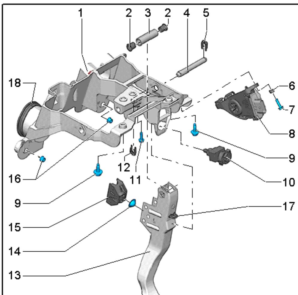
在制动踏板上必须安装挡块 -17-。当制动踏板解锁时，制动信号灯传感器 -10- 的定位架有折断的危险。
